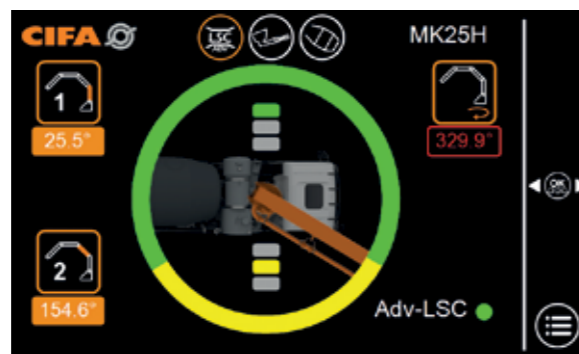
LSC CONTROL DE ESTABILIDAD LUMÍNICA (según EN 12001:2012)
