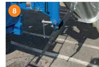
8 Entladeschurre Höhenverstellung über manuellen Zylinder (Handkurbel).
