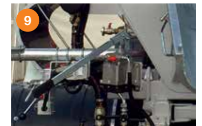
9 Entladeschurre Höhenverstellung hydraulisch über Handpumpe.
