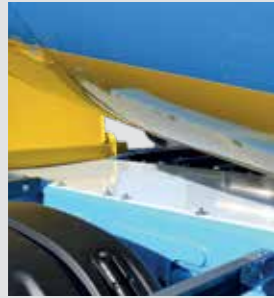
Schutzabdeckung unter der Trommel.
