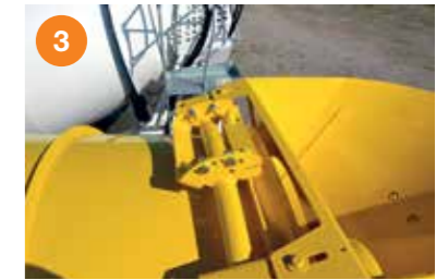
3 Der Fangbügel hält die Trommel während des Transports in Position.
