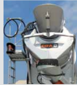
Trommelverschlussystem EKOS und Blinklicht hinten.
