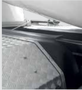
Schutzabdeckung aus Gummi zwischen den Aluminiumkotflügeln und dem Rahmen des Fahrmischers.
