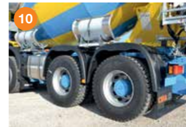
10 Einachs-Polymer-Hinterkotflügel. Doppelachskotflügel aus Aluminium sind auf Anfrage erhältlich.
