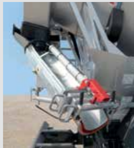
Hydraulische verlängerbare Entladeschurze "SL 45".
