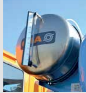
Wasserdruckbehälter aus Aluminium (Kapazität von 200 bis 800 Liter).
