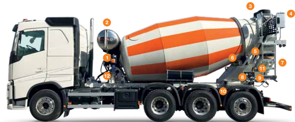
12 Doppelte Wassereinfüllstutzen. Das Wasser kann sowohl von der linken als auch von der rechten Seite des Fahrmischers eingefüllt werden. Kühler mit Öltank. Manometer für die Betonkonsistenz.
