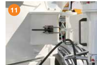
11 Einarmschwinge für die Entladeschurre (für die Serien SL und SLX).
