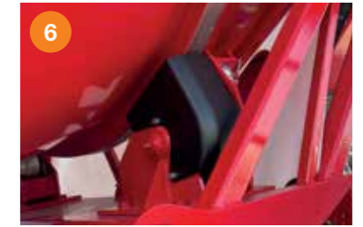
6 Entladeschurre Höhenverstellung hydraulisch über Handpumpe.
