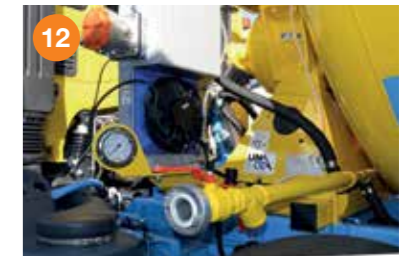
12 Doppelte Wassereinfüllstutzen. Das Wasser kann sowohl von der linken als auch von der rechten Seite des Fahrmischers eingefüllt werden. Kühler mit Öltank. Manometer für die Betonkonsistenz.
