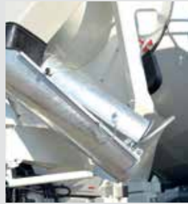
Klappbare Sicherheitsschurze für Zweihandbetrieb (1.200 mm + 600 mm).
