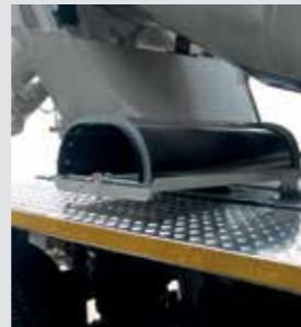
In einem Winkel von 90° angebrachte Ablage für Schurzen unter der Trommel.
