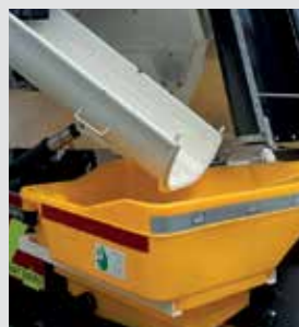
Betonreinigungssystem (Awaywash) - Ausflussbegrenzung für Schurreinigung.
