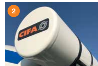
2 Depósito de agua (de 400 a 1200 litros).
