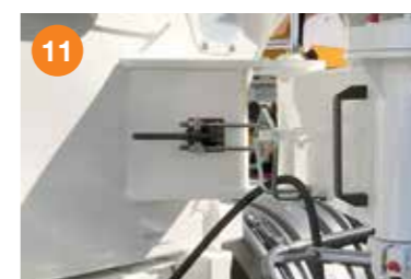
11 Brazo monosoporte para canal de descarga (series SL y SLX).
