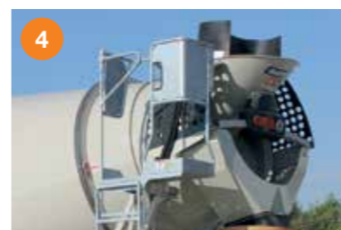
4 Escalera galvanizada en caliente (EN12609)
