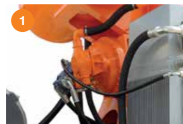
1 Bomba de agua instalada en el reductor.
