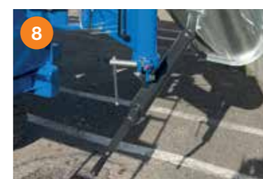
8 Elevación de la canal mediante manivela.
