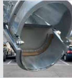
Deflector de la canal de hormigón.
