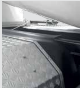
Cubierta protectora de goma entre los guardabarros de aluminio y el bastidor de la hormigonera.
