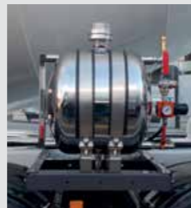
Depósito presurizado de aditivo (50 l.) fabricado en acero inoxidable.
