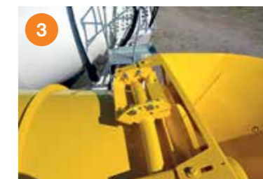
3 Tambor con sistema antirrebote para mantenerlo en posición correcta durante el transporte.
