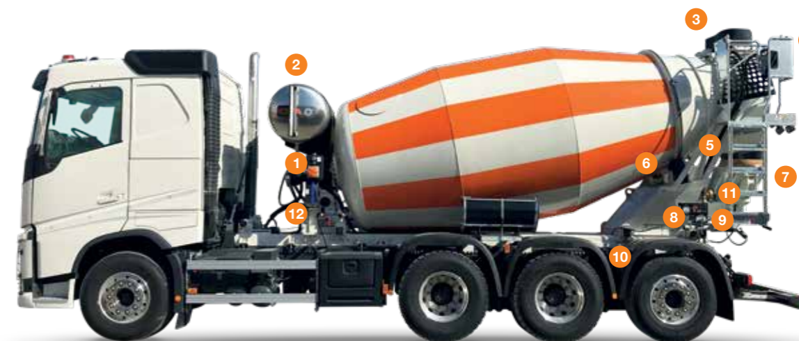
12 Tomas dobles de agua. El agua puede suministrarse tanto por la izquierda como por la derecha de la hormigonera. Intercambiador de calor con depósito de aceite. Manómetro para medir la consistencia del hormigón.
