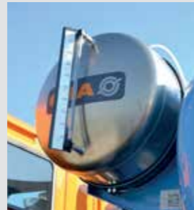
Tanque de agua presurizado de aluminio (de 200 a 950 litros).
