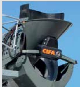
Manga de goma en tolva de carga.
