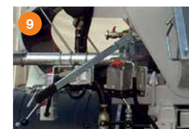
9 Elevación de la canal mediante bomba hidráulica de accionamiento manual.
